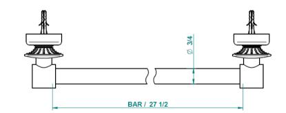
recommended drilling ø ø de perçage conseillé empfohiener abstand Ø de perforación aconsejado
